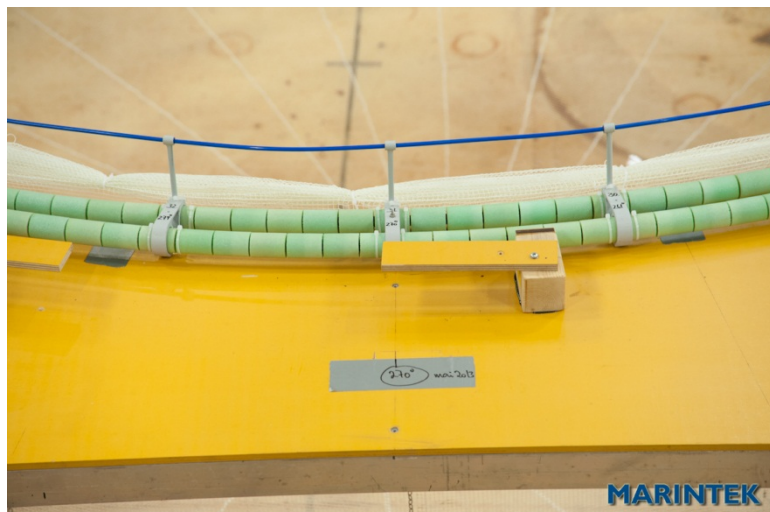
Figur 3.4: Detalj av flyteringen. Dobbelt 450 mm-rør.
