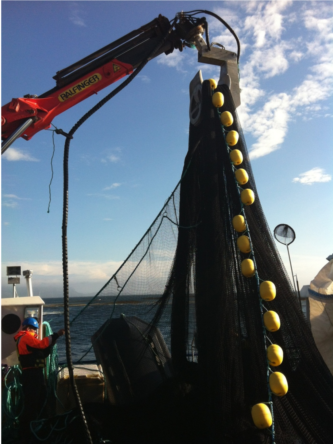
Bilde 1 Håndtering av not med kran.
