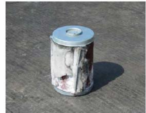
Brukt CO 2 -tørrefilter (GTI, 2006)
