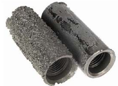
Korrosjon pga. karbonsyre (Hendrics)
