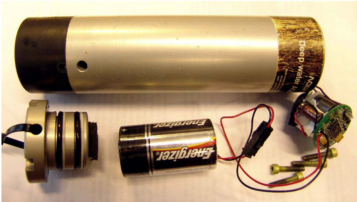
Figur 2 Bilde av elektronikken i Deep Water Aquamark pingerene. Enheten til høyre med printkortet genererer og forsterker lydene. Disse blir sendt til hydrofonen som er den svarte delen av pingeren.
