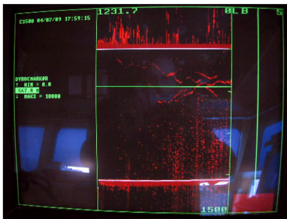
Figur 7 Bilder av ekkoloddskjermen ombord M/S Leinebris som viser spermhval under båten. Spermhvalen kan sees som horisontale strek som bukker seg over skjermen. Skjermen til venstre viser minst fire hvaler som ligger mellom 400 og 700 meters dyp. Skjermen til høyre viser to hvaler som ligger mellom 350 og 450 meters dyp. Her vises også signalene fra scrambleren som vertikale strek. (Foto: Arnstein Leinebø)
