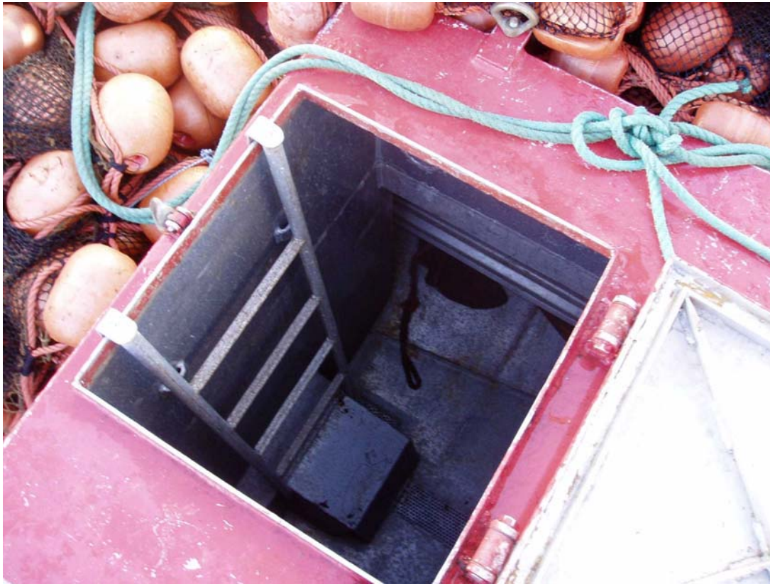
Bilde 14 Nedgang til lasterom med leder akter mot maskinromsskott
