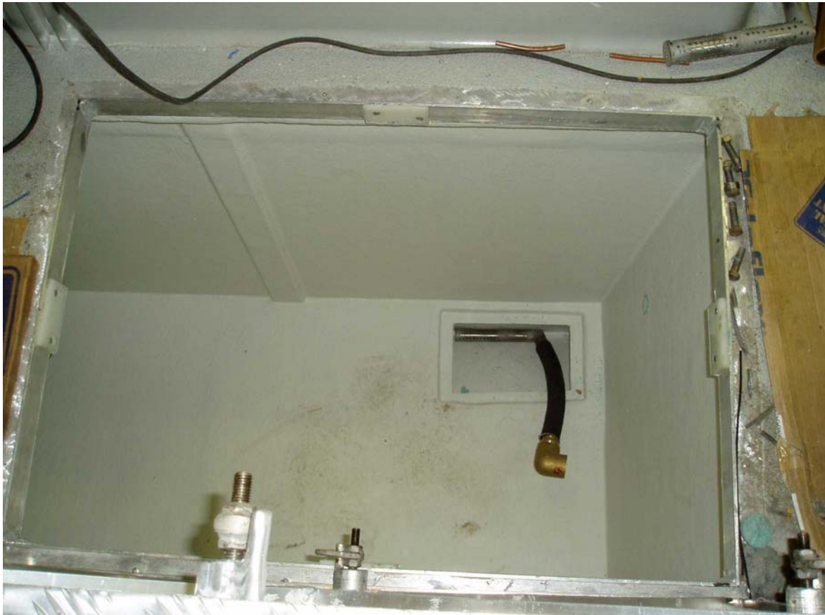
Bilde 10 "Malosjarken" bygges med 3 separate rom for føring av kråkeboller i sjøvann
