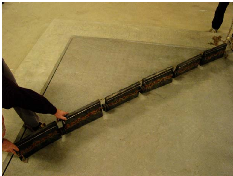
Figur 2. Prototype av sidegear laget av gummiplater
