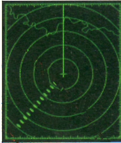
Figur 2.1: Radarsignal fra en SART (Search and Rescue Radar Transponder). Responssignalet sees som en linje bestående av 12 punkter.
