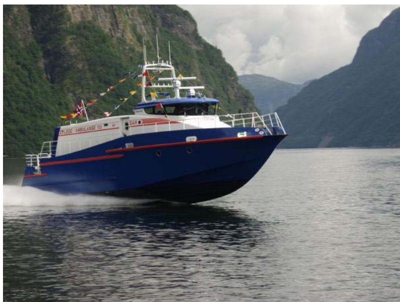
Figur 3.8: Rygerdoktoren. Ambulansefartøy i karbonfiber-sandwich produsert ved vakuuminjisering.
