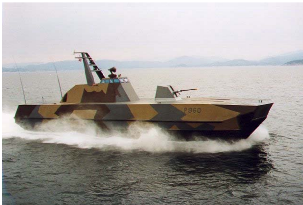
Figur 3.5: MTB'en Skjold bygd i sandwich av Umoe Mandal AS
