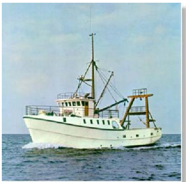
Figur 3.1: 50 m langt fiskefartøy i sandwich fra Greben i Kroatia
