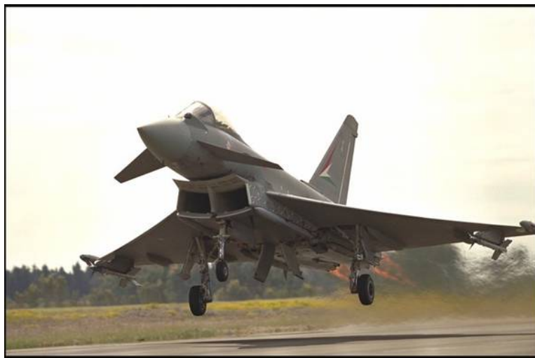
Figur 3.16. Eurofighter Typhon, hvor hoveddelen av skroverflaten er lagd i karbonfiberarmert kompositt.
