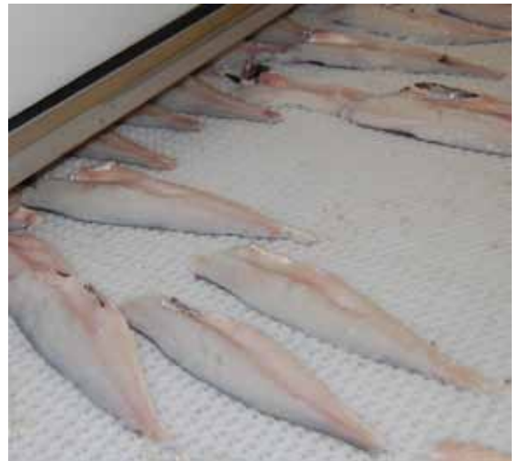
Figur 1 Hysefileter på vei inn i Skogin CBC (Combined Blåst and Chill) kjøler
