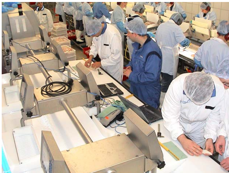
Fig. 3.1 Bildet viser testoperatørene (i forgrunnen) som foretok undersøkelse av filètene mht restbein, måling av beintykkelse og –lengde samt tilstand og posisjon i filèten. Resultatene ble umiddelbart registrert i regneark på PC. Testene foregikk på bedriften Samherji hf i Dalvik på Island.
