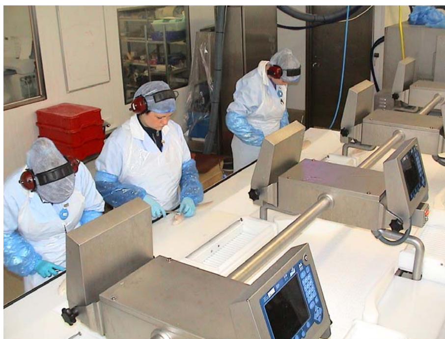
Fig. 6.4 Stasjon for ettertrimming, plassert etter SensorX. Filèter med restbein fordeles automatisk til ledig operatør som trekker ut restbein med tang og foretar kontroll på at filèten er helt beinfri. Operatørene bruker aktivt informasjonen på displayet om hvor restbein befinner seg i filèten. Stasjonen har forbedringspotensiale for ytterligere effektivisering og bedre ergonomi.
