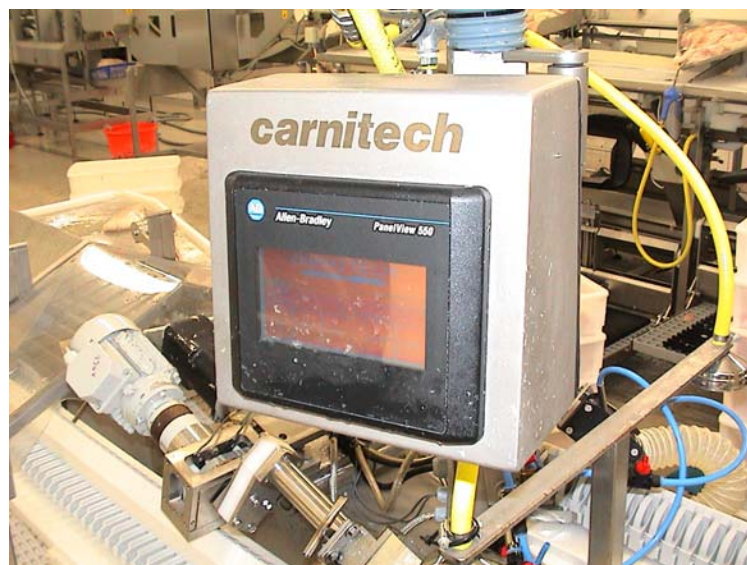
Fig. 4.2 Kommunikasjon mellom operatør for Pinbone-maskinen og maskinens PLS skjer via et display der operatøren kan velge verdier for parametere som inngår i styringen. Vha displayet startes og stoppes maskinen.
