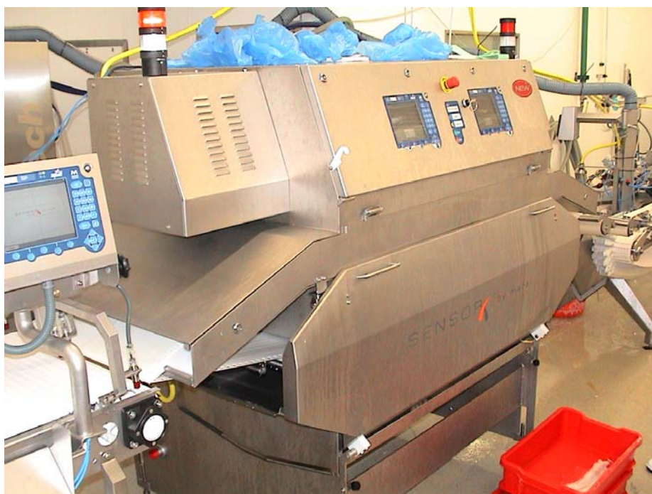
Fig. 5.1 SensorX montert i prosesslinjen i Dalvik. Til høyre på bildet skimtes Pinbone-maskinen. Til venstre er utløpsenden av SensorX. SensorX er utstyrt med egne små display for kommunikasjon mellom operatør og maskinens styrefunksjon, gjelder bl.a. statistikkdata. Maskinen kan koples til PC for utveksling av data om røntgenbilder og behandling av disse, samt endring av funksjoner og styringsparametere.
