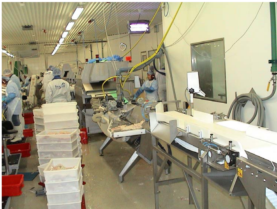
Fig. 6.3 Automatisk veiing samt kontrollstasjon til høyre på bildet. En operatør mater filèter inn i Pinbone-maskinen. Bak Pinbone-maskinen står SensorX.
