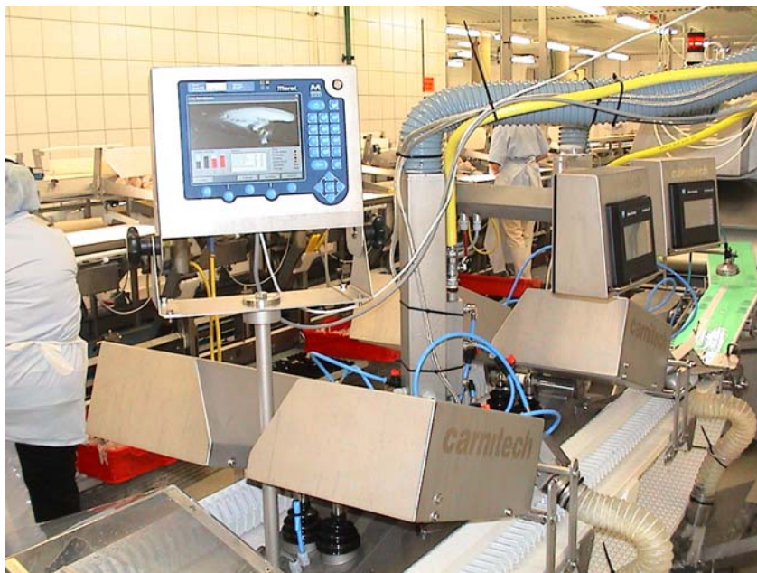
Fig. 4.5 Pinbone-maskinen er i utførelse kalt Maskinprototyp VI utstyrt med eget display der resultater fra SensorX-registreringer vises. Dette gir rask tilbakemelding til maskinens operatør under en prøvekjøringsfase om de endringer som er gjort falt heldige ut.
