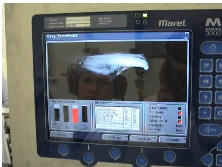
Fig. 5.2 Display som viser resultater av røntgendeteksjonen i SensorX med tilhørende statistikkdata er blitt oppgradert for testen i september 2003. Systemet gir detekterte tykkfiskbein en rød farge og øvrige detekterte bein en gul/orange farge. Systemet skiller mellom disse to beinkategoriene. Andel filèter fri for alle beintyper beregnes, andel fri for tykkfiskbein likeså. Andel filèter fri for tykkfiskbein i de 3 sonene "front", "middel" og "tail" registreres. Sonene har tilknytning til det området av filèten der tykkfiskbein er lokalisert. Ved analyse av ny filèt blir den aktuelle stolpen i displayet rød (detektert bein) eller grønn (fri for bein), ellers sort.
