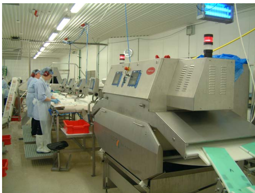
Fig. 11.6 Deler av trimmelinjen for tykkfiskbein, SensorX i forgrunnen og stasjon for manuell beinnapping (ettertrimming) i bakgrunnen.
