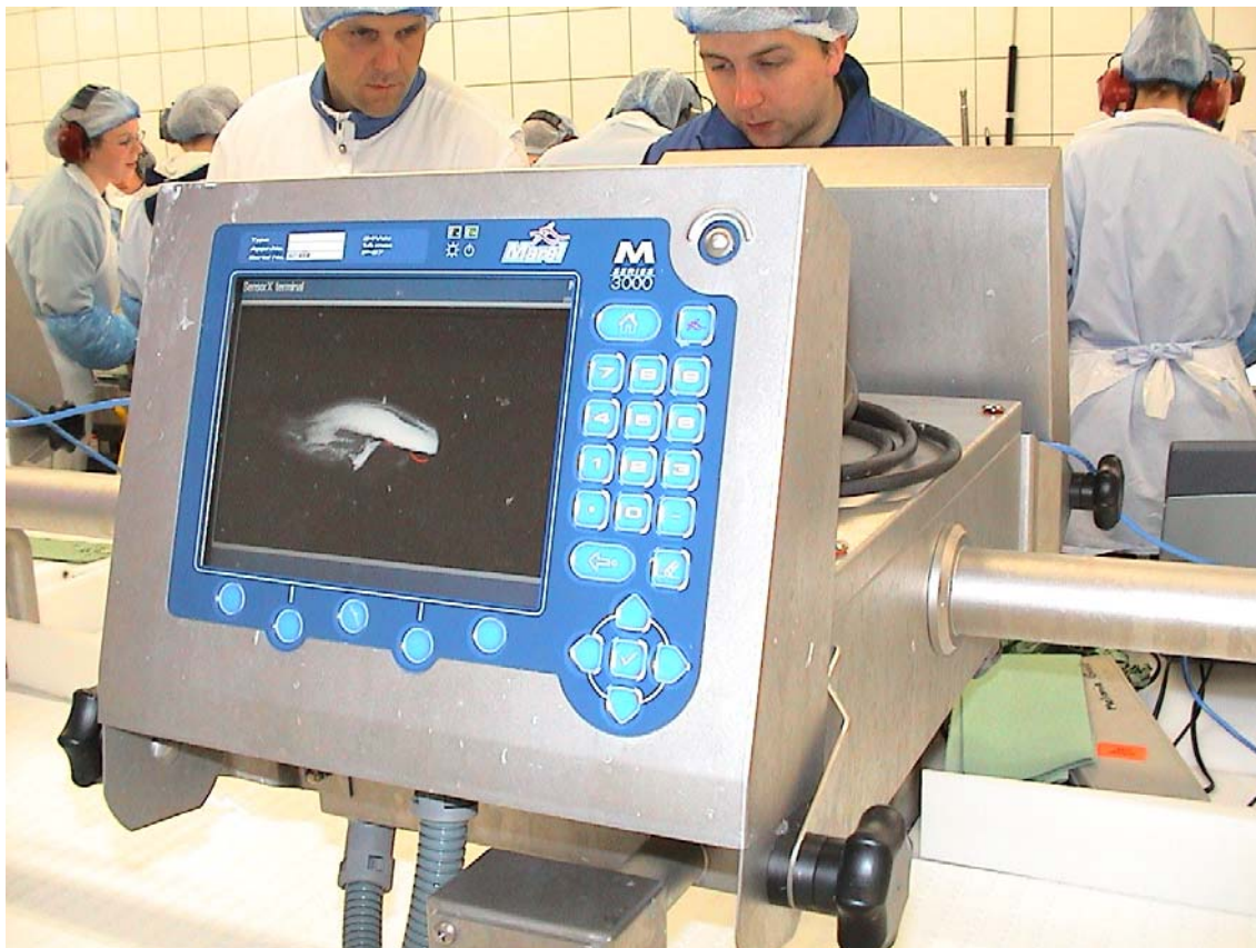
Fig. 6.5 Display montert på stasjon for ettertrimming. Systemet gir rød markering der SensorX har funnet tykkfiskbein i filèten. Juni 2003.
