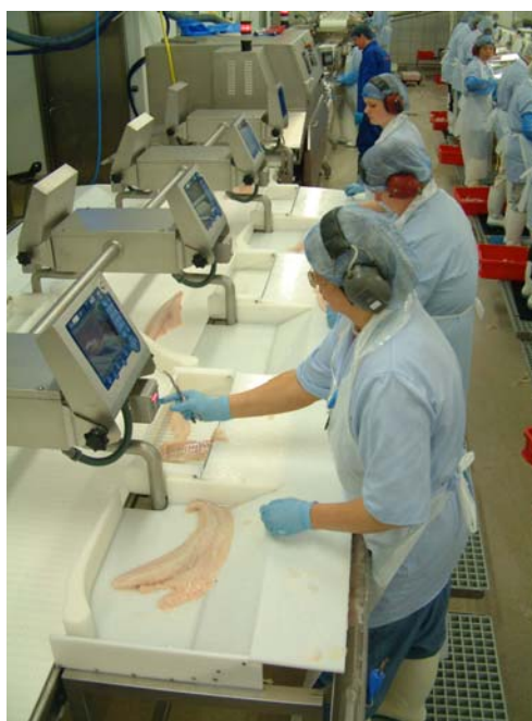
Fig. 6.8 Stasjon for ettertrimming. Operatøren nærmest gir signal til systemet om at en filèt er ferdig behandlet ved å trykke på knappen.
