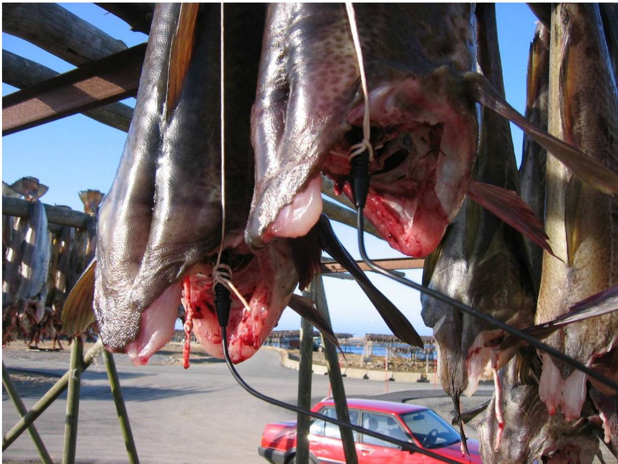
Bilde 1 Opplegg for måling av temperatur i fisken
