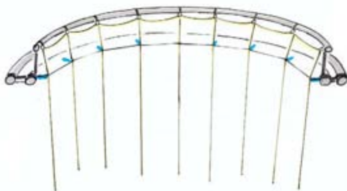
Figur 6.3. Fleksibel infesting av not i flytekragen med bruk av gummiringer.
