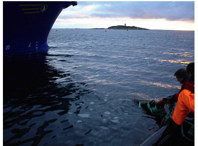
Bilde 4 Slakk hanefot har blitt trukket inn i baugpropell.
