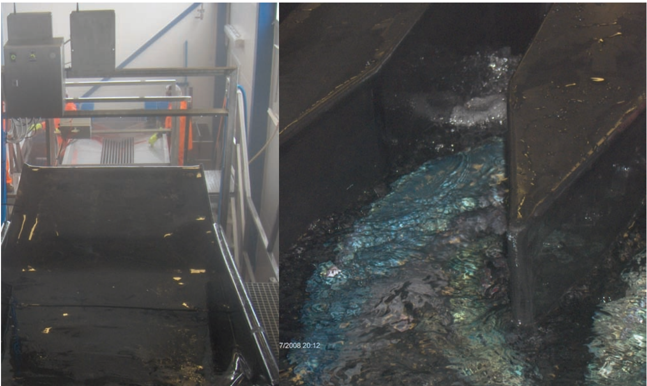
Figur 7. Bildet til venstre viser et adferdskar tildekket med svart matte. Kontrollbordet der fisken kommer ut etter slag og bløgging (slagmaskinene ikke synlig) ses øverst i bildet. Bildet til høyre viser den blå ryggen på en ørret som befinner seg i båsen, på vei ut av adferdskaret. Legg merke til vannstrømmen.
