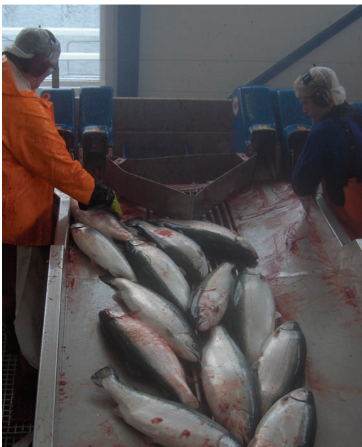
Figur 29. Slakteri C. Bildet er tatt fra utløpet av SI-5 riggen og viser regnbueørret på kontrollbordet. Backup-maskiner for slag og bløgging ses på hver side. Passasjen rett ut til transportbåndet som fører fisken til utblødningstanken er stengt av, og all fisk må ledes gjennom en av backup-maskinene.
