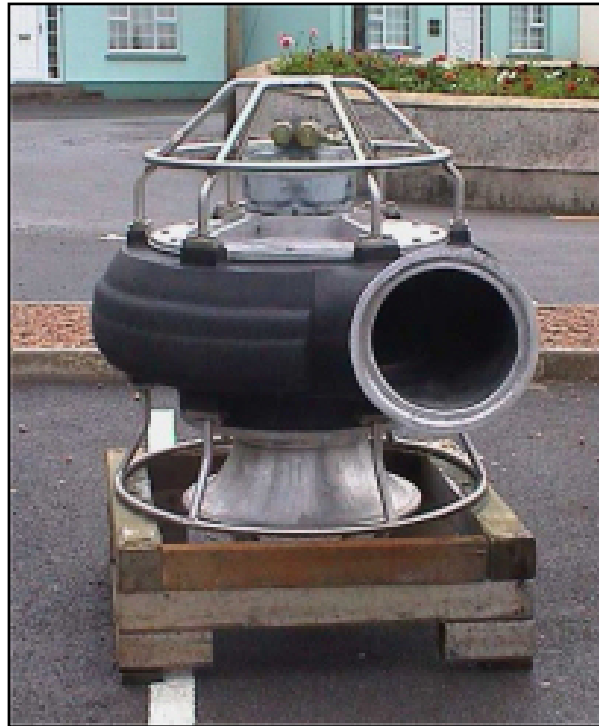
Bilde 21 Impellerpumpen, som i dette forsøket viste seg å påføre fisken skader.
