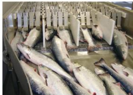
I bedøveren fra Kjølås Stansekniver går strømmen fra stålameller, gjennom fisken og ned i transportbeltet.
