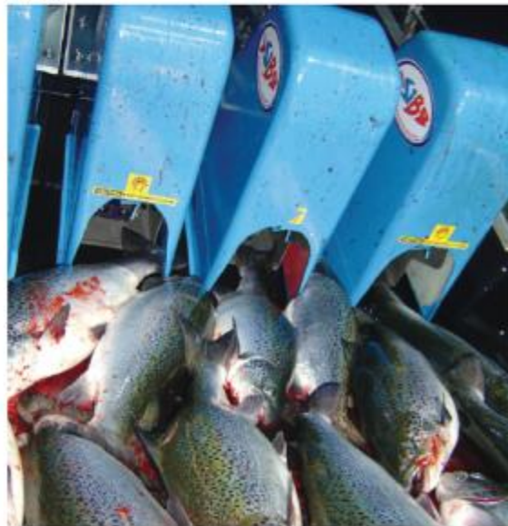
I det australske slaktesystemet fra Seafood Innovations svømmer fisken selv inn i slagmaskinen og blir deretter automatisk bløttet.
