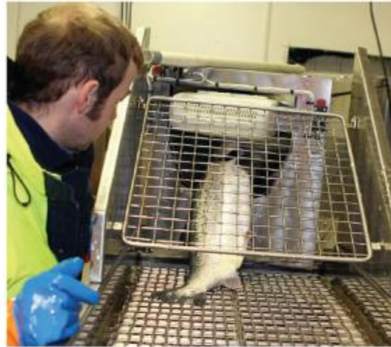
Bedøveren til Sotra Maskin Produkter består av en todelt renne hvor strømmen passerer gjennom fisken fra den ene til den andre siden av rennen.
