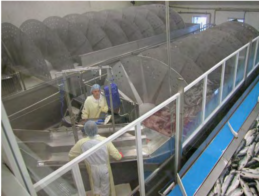
Figur8 8 Fisken pumpes fra brønnbåt eller ventemerd over i et RSW levendekjølingskar. Deretter blir bedøvd fisk bløgget manuelt hvorpå fisken blør ut (avlives) i et RSW utblødningskar.
