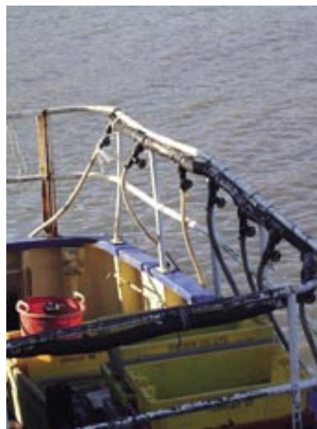
Eksempel på enkelt vanningssystem koplet til spylepumpa.
