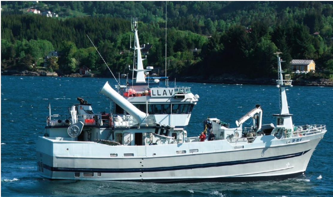
Bluefin er bygget i kompositt-/sandwichmaterialer av Mundal Båt AS. Bildet visert fartøyet etter en forlengelse fra 70 til 90 fot.
