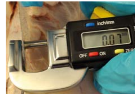
Fig. 3: Måling av svarthinns tykkelse
