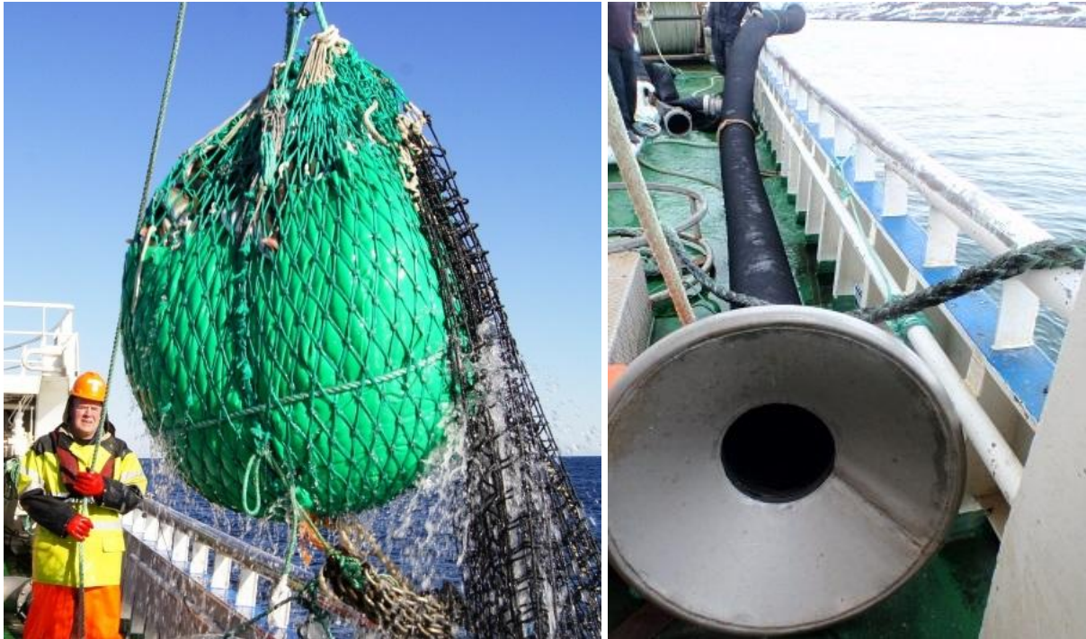
Figur 2.1.2. De to brukte metodene for ombordtaking, sekking og pumping.
