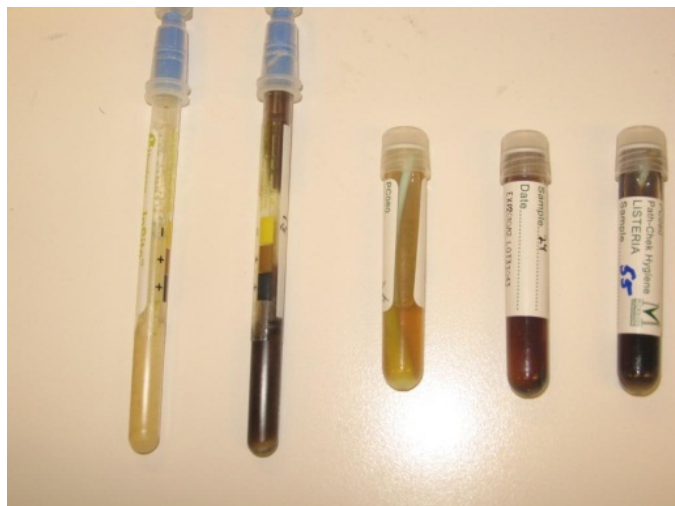
Figur 1 Dyrkingsbaserte hurtigmetoder. Metodene inkluderer svaber for prøvetaking og rør med vekstmedium som svaberen overføres til etter prøvetaking. Tilstedeværelse av listeria i prøven skal gi enzymatisk fargereaksjon som avleses visuelt etter 24-48 timers inkubering ved 30 eller 37 °C. Potensielt listeria-positive prøver (nr. 2, 4 og 5 fra venstre) får fargeomslag fra strågul til mørk brun/svart, mens listeria-negative prøver ikke skal endre farge.
