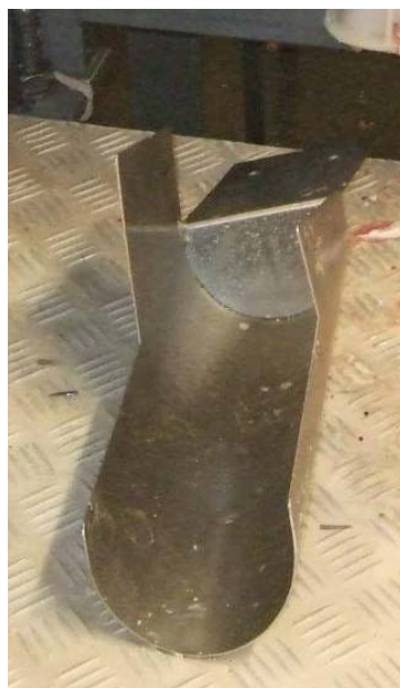
Figur 2 Renne for uttak av rogn og melke, levert fra maskinprodusent.
