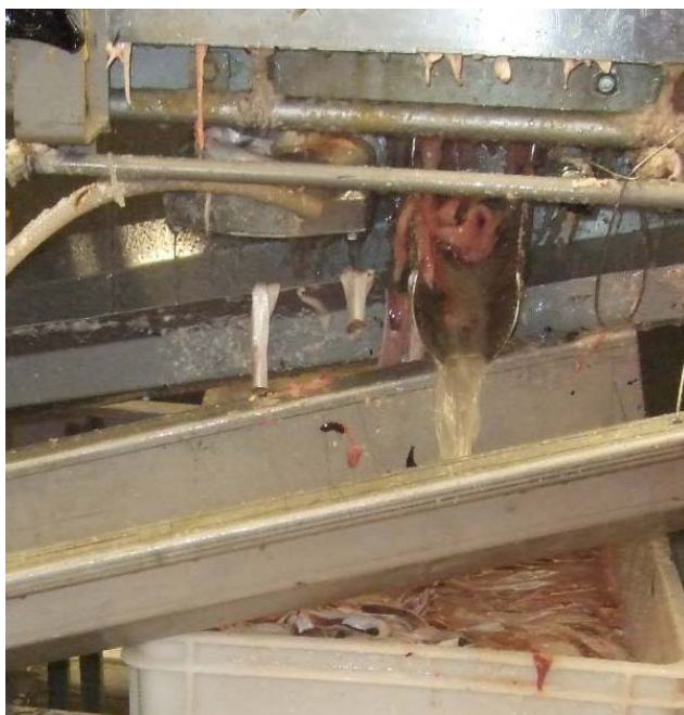
Figur 2 Renne for uttak av rogn og melke, levert fra maskinprodusent.
