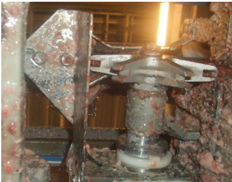
Figur 3 Nedfallssone for buklist (til venstre for skillevegg) og for gonader og innvoller (under rensehjul) i filetmaskin, sett nedenfra.
