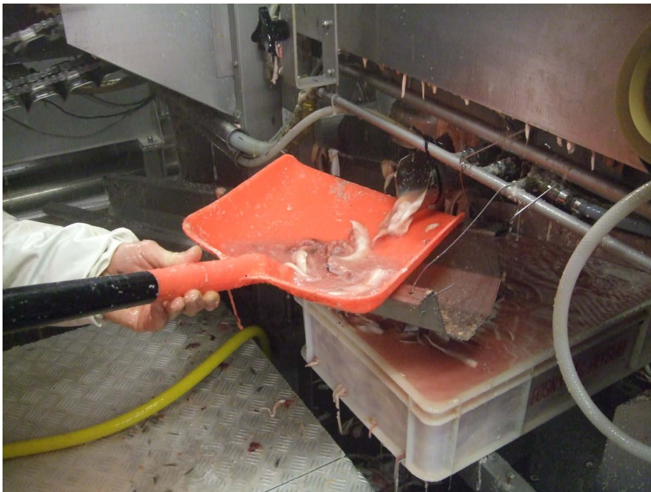
Figur 13: Utløp for rogn og melke under filetmaskin.
