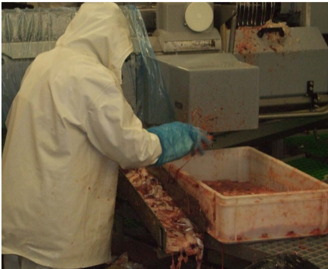
Figur 11. Manuell plukking av silderoغن (separering fra øvrig bukholeinnhold) fra uttaksrenne under filemaskin.
