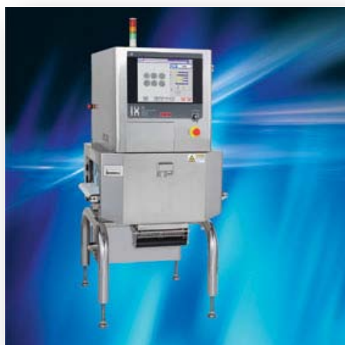
Figur 6 – Ishida modell IX-GA-2475 (Japan) beregnet på røntgen on-line deteksjon av fremmedlegemer i ulike produkter. På grunn av begrenset størrelse av deteksjonsområdet på denne modellen, var det nødvendig å scanne hver fisk flere ganger. Røntgenbildene ble i etterkant 'sydd sammen' til et større bilde som representerte en hel klippfisk. (Referanse: www.ishidaeurope.com ).
