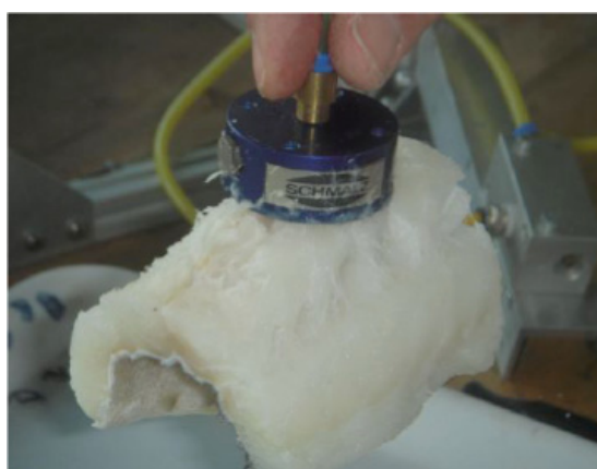
Figur 4-4: Griping av filet (Single Point)
