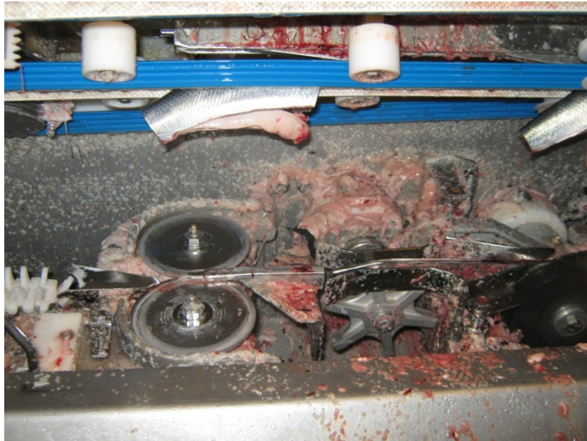
Figur 3-6: Bukkniv og utskrapingshjul
