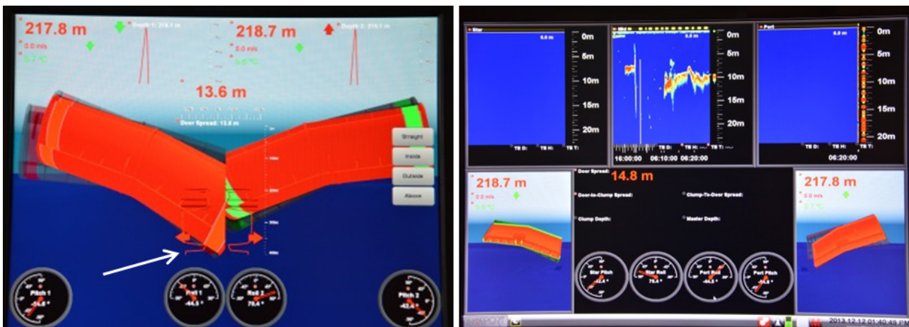
Figur 10: Bildene viser informasjon fra Marport sensorene: Båten er i sving og begge bunntåldørene har mistet spredning (til 13-14 m) og legger seg på bunnen.
