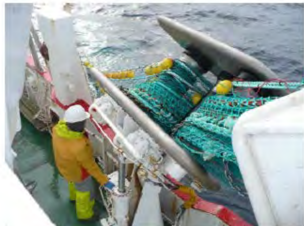
Bilde 6-10 Tørring av snurrevadssekk ved bruk av kraftblokk (notvinsj) (foto: SINTEF Fiskeri og havbruk)
