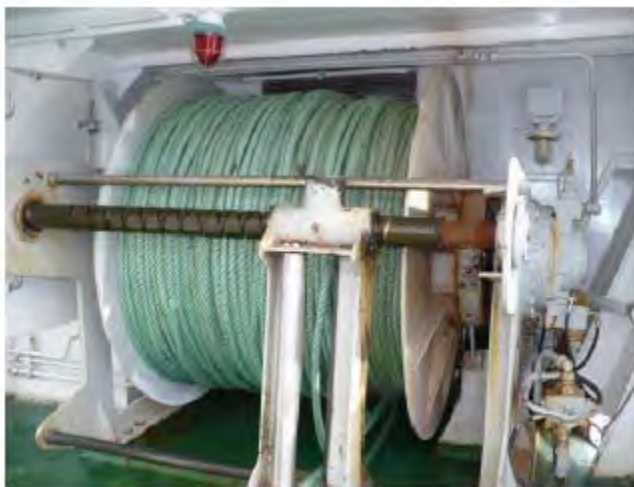
Bilde 6-6 Kombinasjonsvinsjer – 12 tonn - for snurrevad, not og evt. trål (foto: SINTEF Fiskeri og havbruk)
