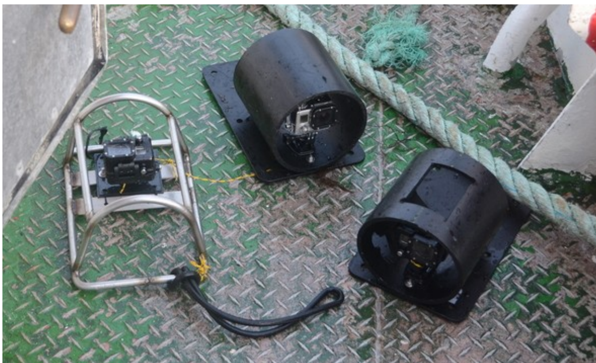
Figur 2. GoPro kameraene i beskyttelsesrammer av stål og plastrør på skjærefjøl.
