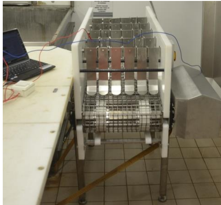
Elbedøver bygd med motelektrode i stålbånd (lik lakseslakteri)
