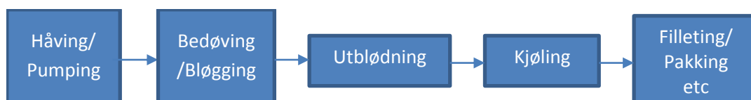
Figur 4.1 Operasjonene i en slakteprosess vist skjematisk
