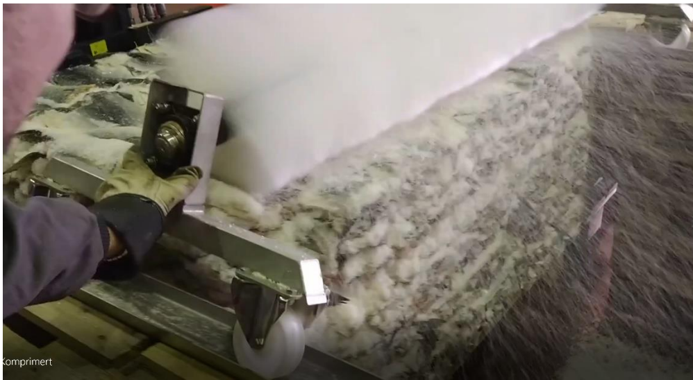
Figur 7 - Testing av separat børsteenhet for fjerning av salt.
