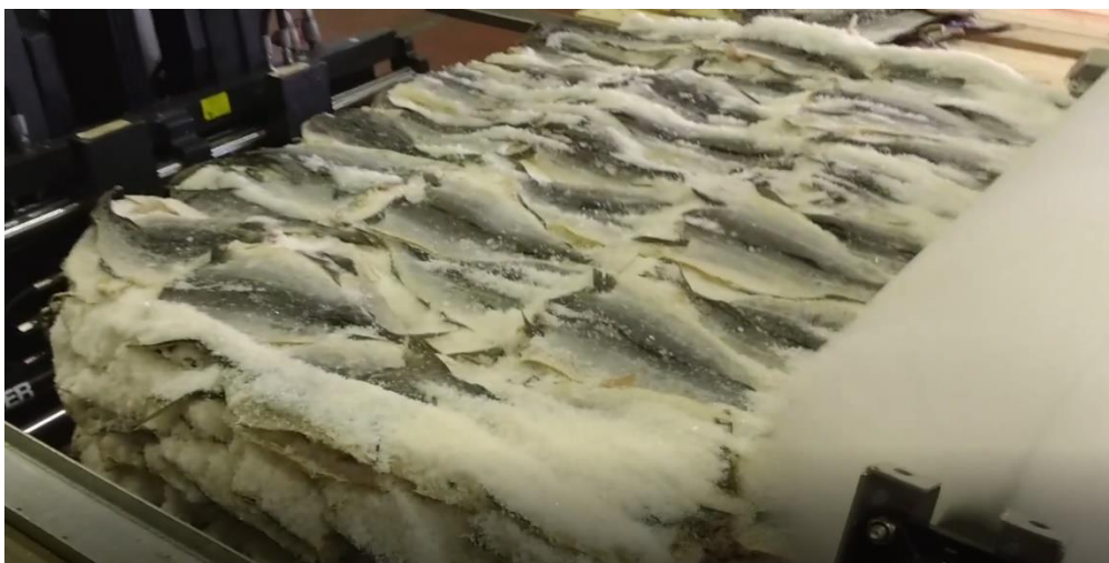
Figur 8 - Overflaten til fiske-pallen etter at børsteenheten har passert en gang.
