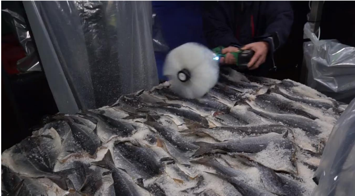
Figur 5 - Første test av børste som verktøy til å fjerne salt fra overflaten til fiske-pallen.
