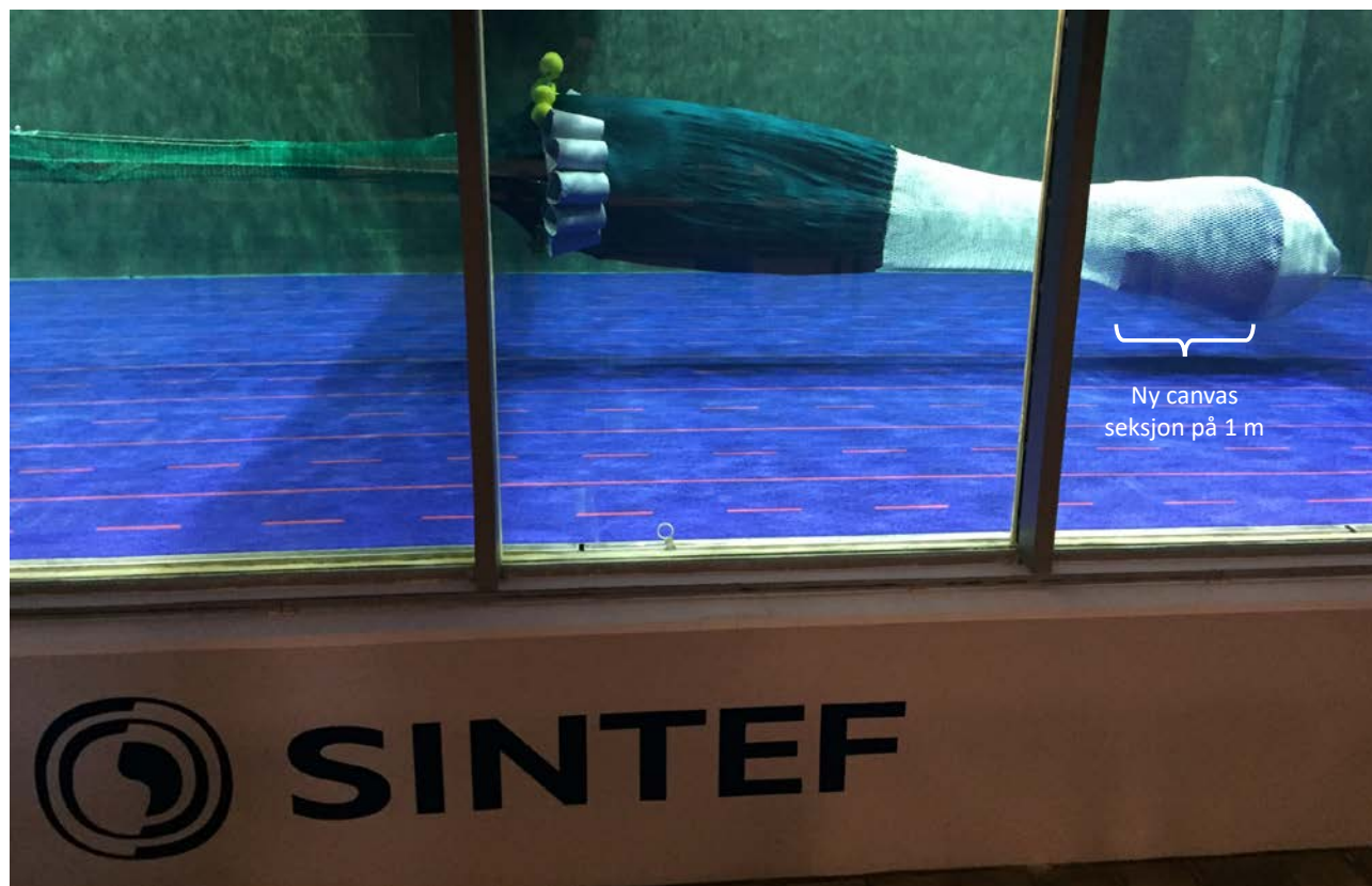
Figur 7. Som Case 4 (Figur 6), men ekstra 1 m lang canvas-seksjon innsatt bakerst i diamantmaskeseksjon.
