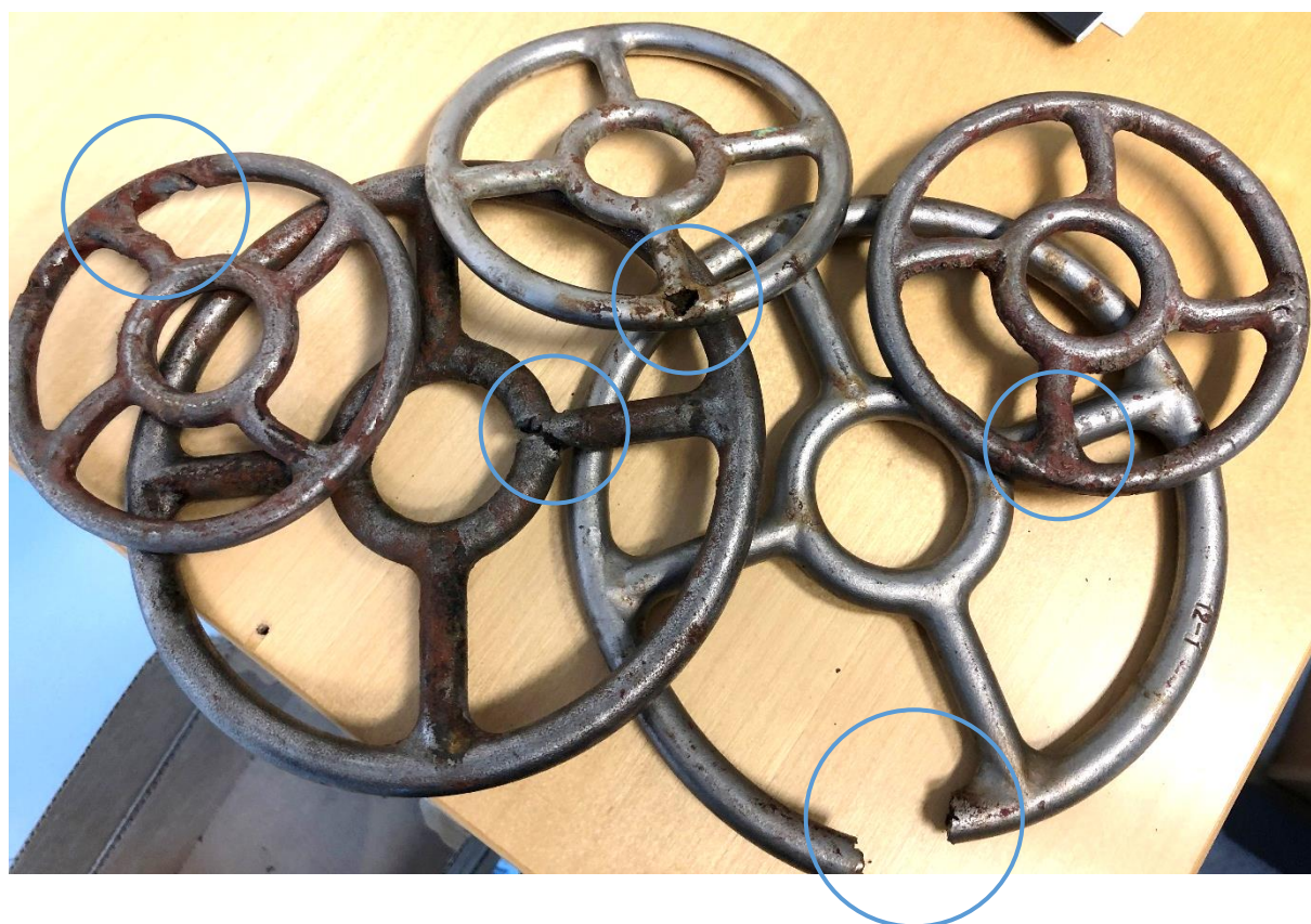
Figur 14: Senterringer og ringer til loddssystem med korrosjonsskader.
