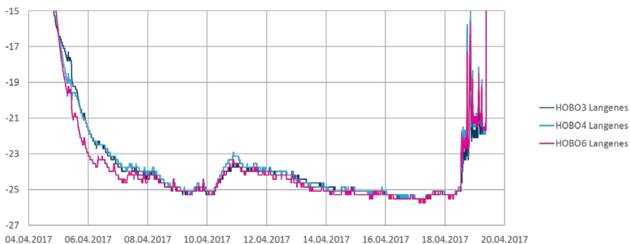
Figur 10. Temperatur under transport for blokker fra Langenes.
