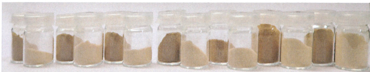
Figur 13: Frysetørket hydrolysat. Sentrifugering av hydrolysat før tørking påvirker i stor grad fargen og opplevelsen av hydrolysatet. De lyse hydrolysatene har høyere proteininnhold, lavere fettinnhold, framstår tørrere og av høyere kvalitet. (Foto: Jannicke Fugledal Remme, SINTEF Ocean)
