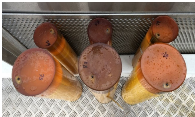
Figur 1 – Sensorfiskene som ble benyttet ble laget i to størrelser som forenklet tilnærming til laks i størrelsene 2,5 og 5 kg.
