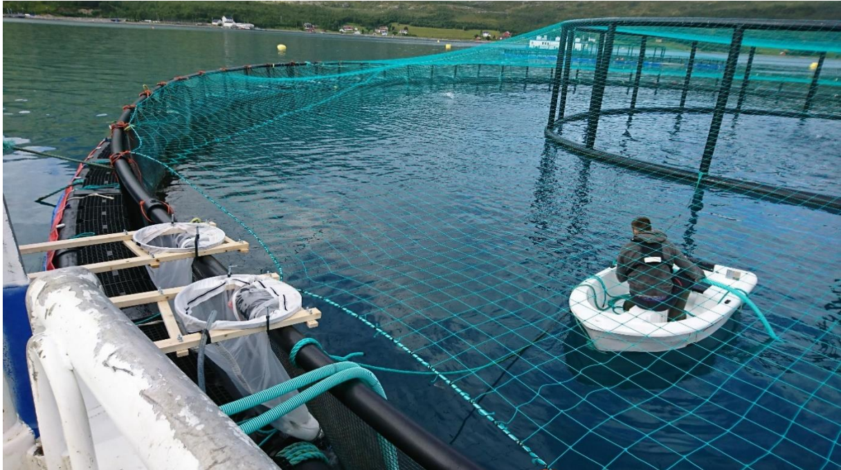
Bilde 3. Pumping av vannprøver og filtrering for oppsamling av plankton.
