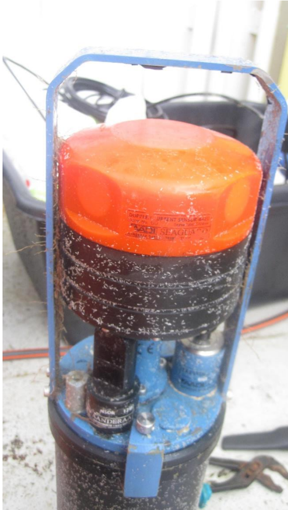
Figur 4. Aanderaa Seaguard I etter første måleperiode fra 12. juni til 23. august 2018 ved Uløybukta (foto: Øyvind Leikvin, 23.08.2018).
