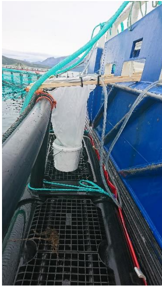
Bilde 4. Planktonsil (t.v.) og to pumper i drift (t.h.) på arbeidsbåt for pumping av vannprøver gjennom planktonsil.
