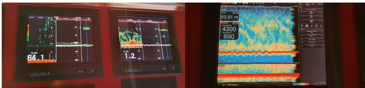
Figur 2: Ekkogrammer på Engelsk Klondyke nord, 10.04.2021 kl. 07:00 CET. Til venstre er 50 kHz og 200 kHz ekkogrammer. Til høyre er 38 kHz ekkogram.
