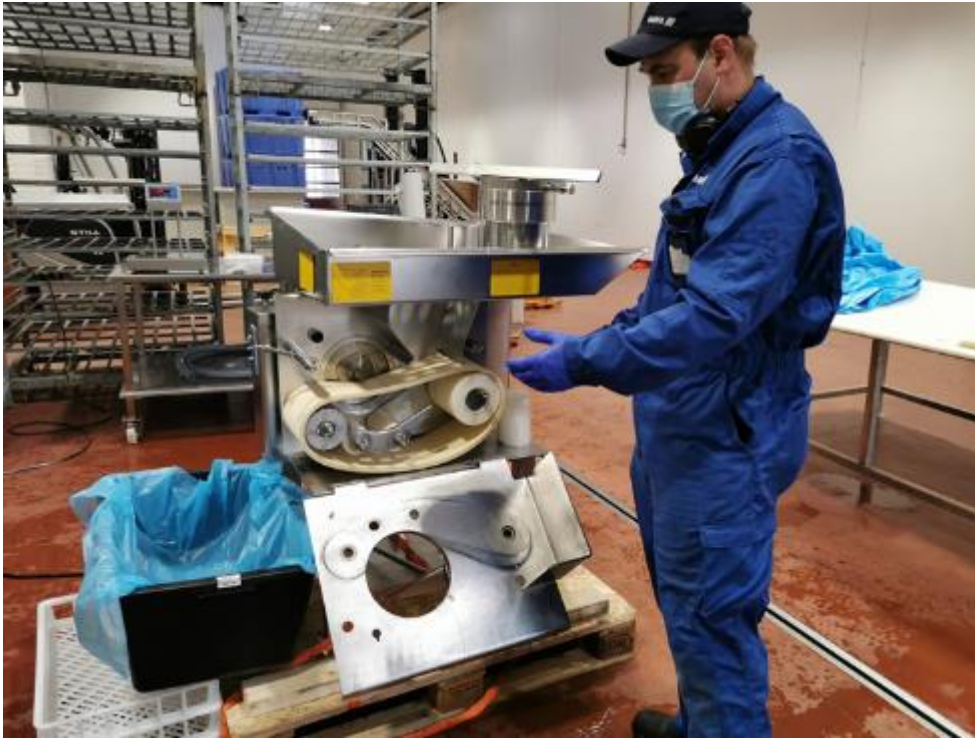
Figur 4 Farsemaskinen Baader 600 med mekanisk justering av trykket på båndet (det hvite båndet rundt de to rullene. Trommel oppå maskinen er klar til montering.
