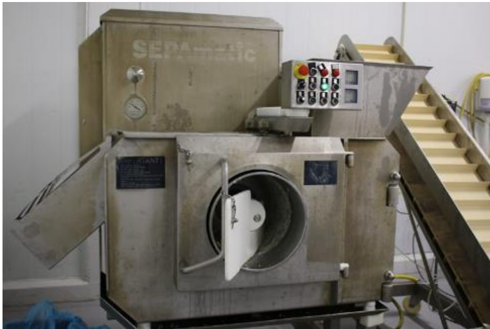
Figur 7 Sepamatic farsemaskin som ble brukt under testingen hos Maritim Food AS.
