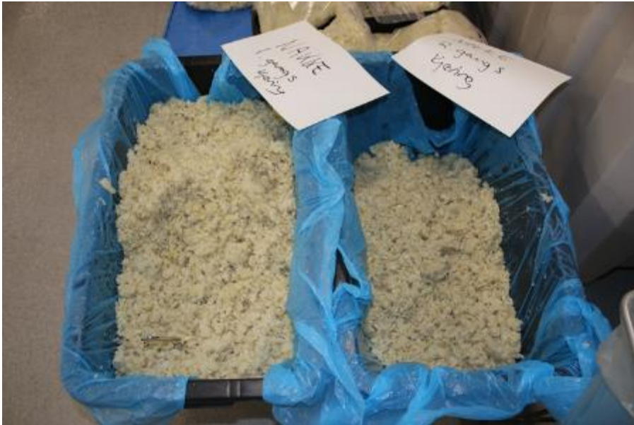
Figur 40 Farse av utvannet saltfisk nakke-biter etter første kjøring (t.v.) og andre gangs kjøring (restfraksjonen ble kjørt ytterligere en gang til gjennom maskinen).
