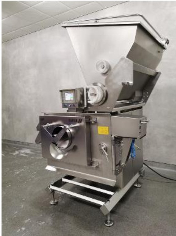
Figur 10 Farsemaskin type Baader 604 på teststasjonen til Baader i Lübeck, Tyskland.
